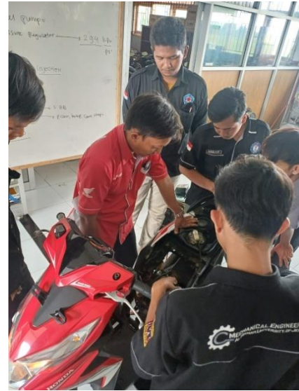
Gambar 3. Pemeriksaan sensor throttle position
