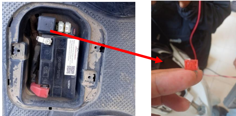
Gambar 4. Praktik Pemeriksaan Baterai dan Saklar Sepeda Motor
