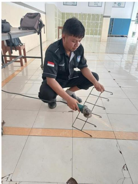
Gambar 3. Demonstrasi gerinda tangan
